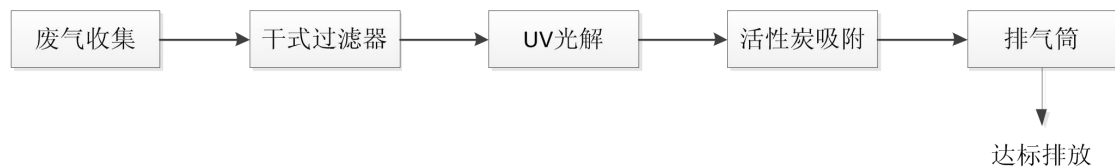
图 4.1-1 “UV 光解+活性炭吸附”工艺流程图
